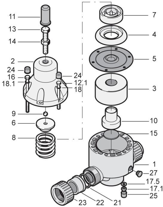
Fig. 5 Drawing DHV 712-R PVC-U, PP, PVDF
